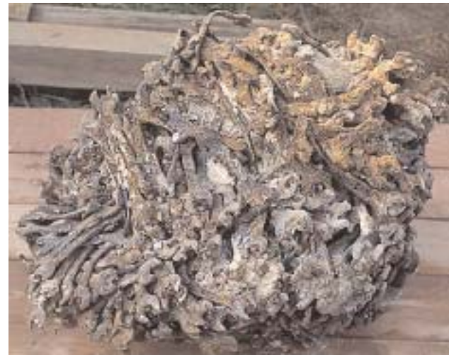
Zusammengeschmolzene Schraubenzieher aus dem Lager der Fa. Morgenstern
